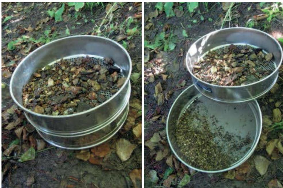
Figure 2. Colonne de tamis pour le conditionnement des échantillons récoltés à l'aide de l'épuisette.
